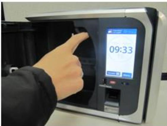
**Passo 3:** Mova para baixo a alavanca para abrir a tampa da impressora.
