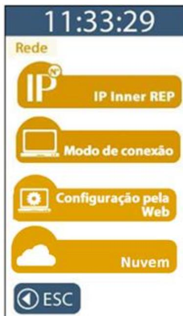
Em seguida defina se o Rep será configurado com IP fixo ou com IP automático (DHCP). O Rep só poderá ser configurado para DHCP se a rede tiver um serviço de DHCP ativo. O DHCP no Inner Rep Plus funciona independente do “**Modo de conexão**”, ou seja, tanto para “**Inner inicia conexão**” habilitado ou desabilitado .
