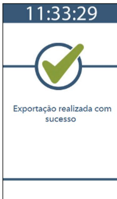
O Inner Rep Plus gravará no pendrive arquivos diferentes para cada tipo de exportação. Para o Inner Rep Plus LFD, podem ser gerados até 10 arquivos para salvar a biometria, cada um armazenando até 1.000 empregados com uma ou duas digitais.
